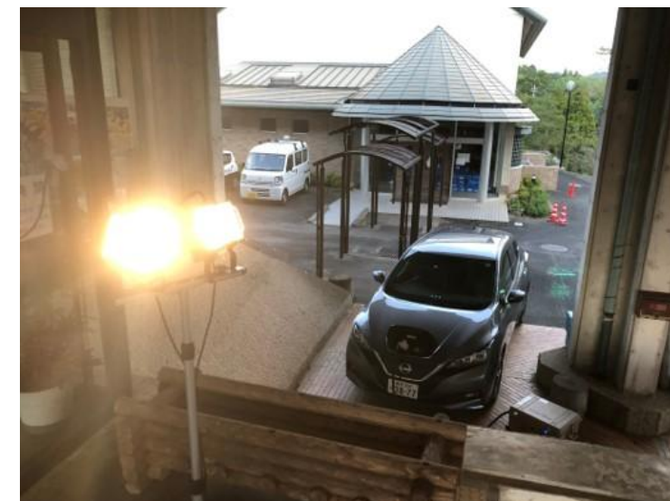
電気自動車「日産リーフ」からの電力供給の様子 (日産自動車さまWebサイトより)
