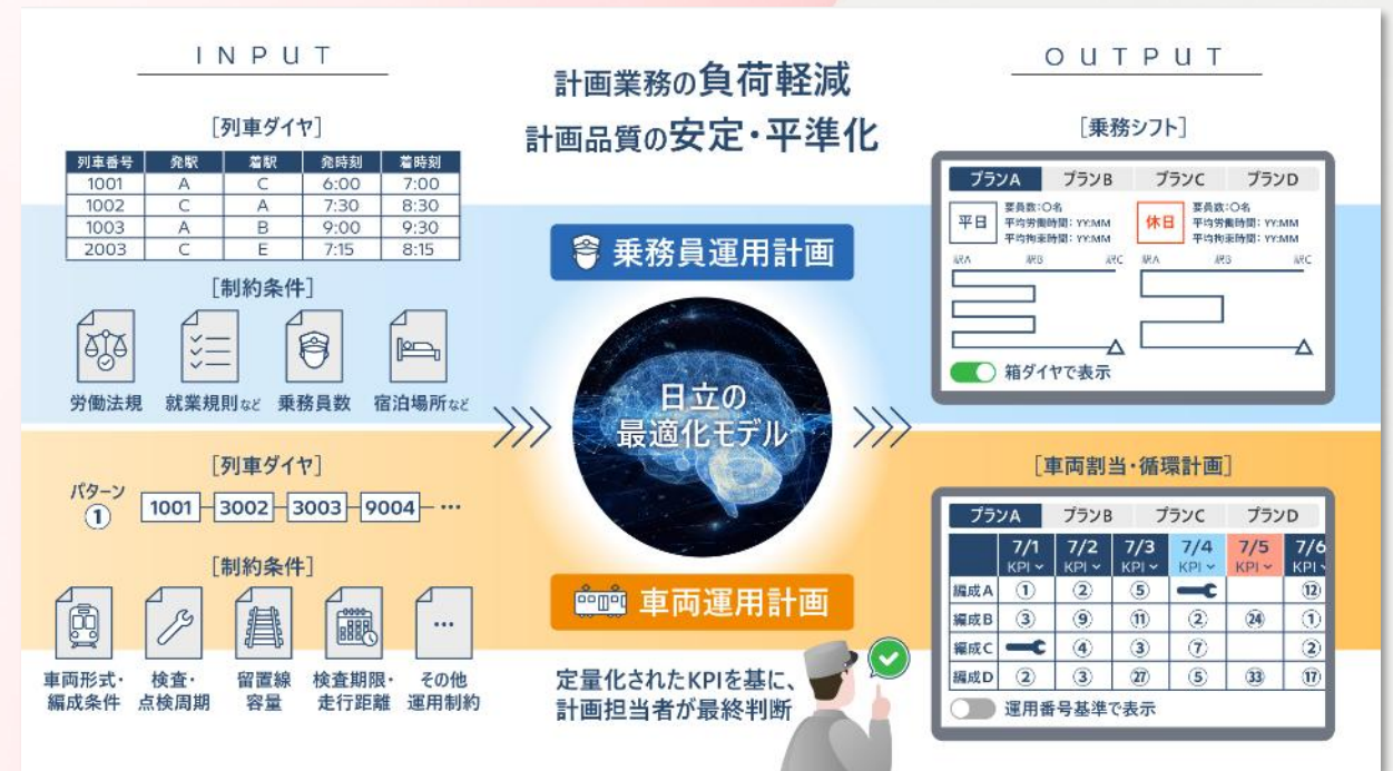
図：CMOSアニーリングを活用した鉄道運用計画の自動作成・評価 出典：株式会社日立製作所 ニュースリリース(2026年7月14日)
